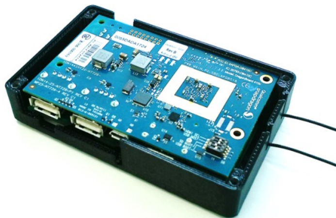
ドローン搭載用4G通信モジュール （出典：NTTドコモのHP）
