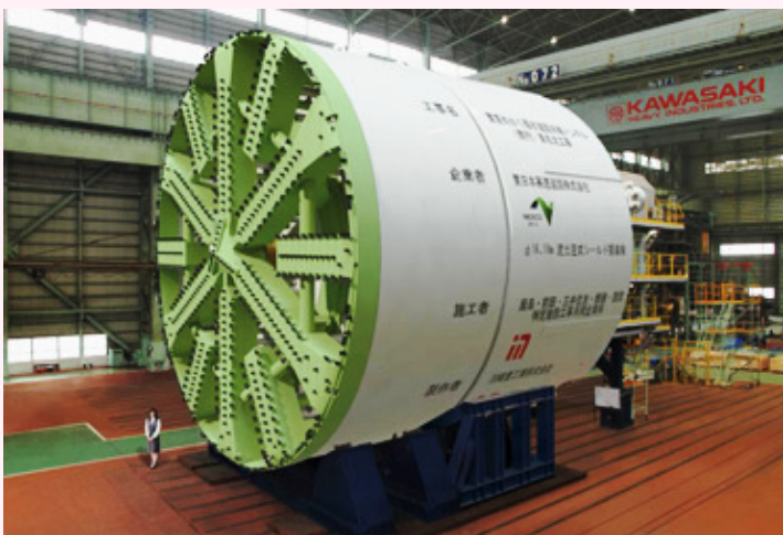
直径約16mの大型気泡シールドマシン（出典：鹿島建設のHP）
