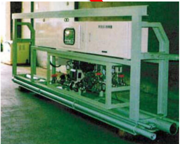
気泡注入制御装置
